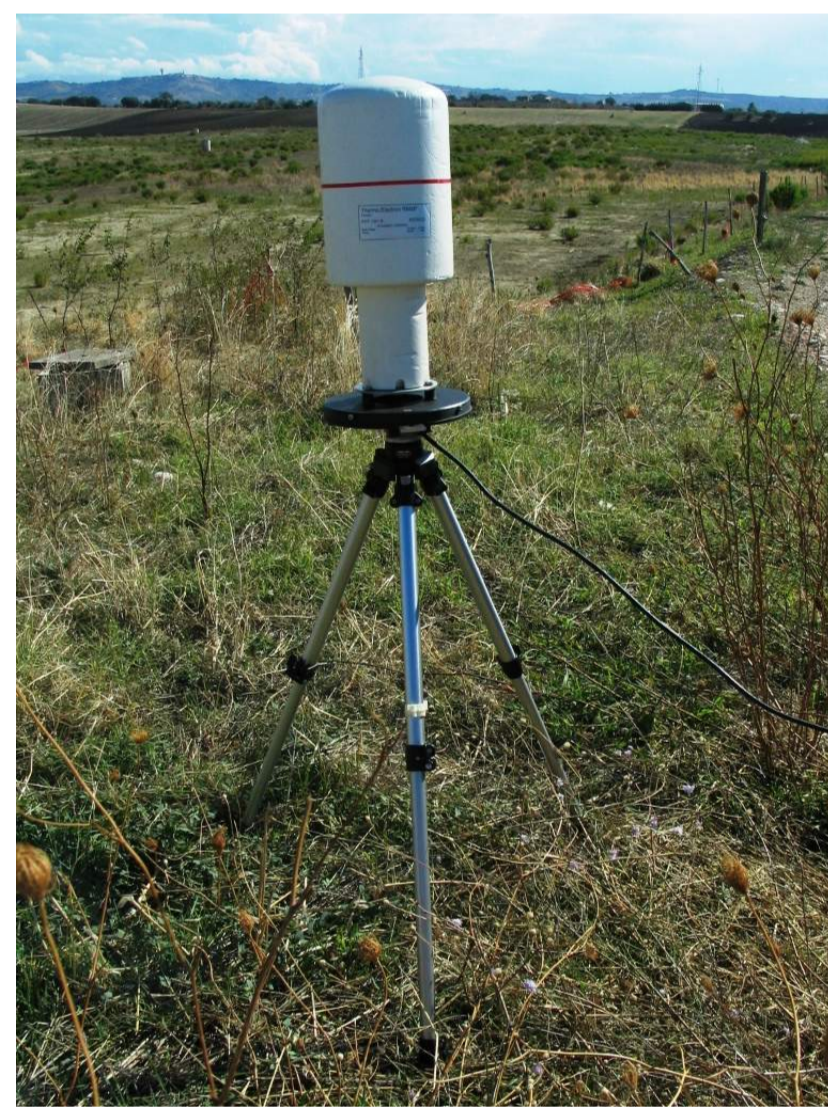
Misure di rateo di dose \gamma in aria con camera a ionizzazione Thermo FHT 191 N a pressione con azoto a 7 atm e volume sensibile 5 litri.
