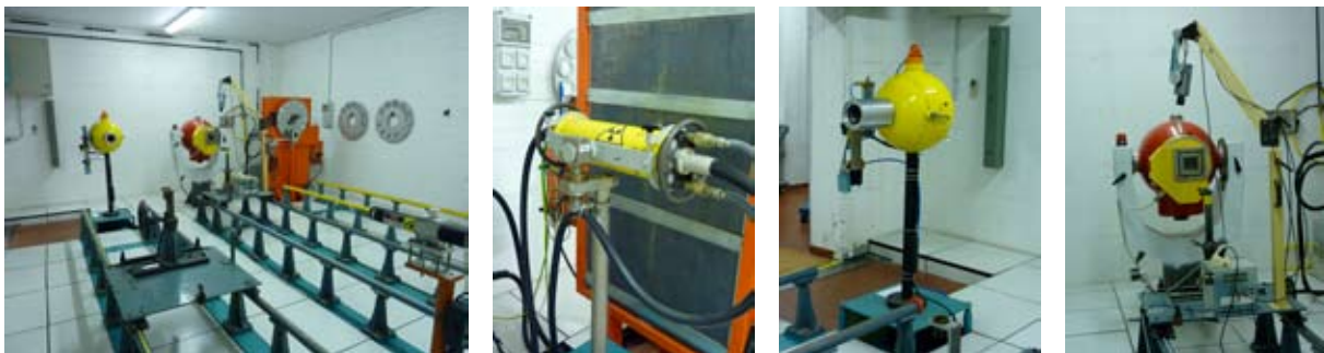
Figura 3 | Sala per l'irraggiamento dei dosimetri personali e particolari del tubo a raggi X da 320 kV, della sorgente di ^{137}\text{Cs} e ^{60}\text{Co} .
