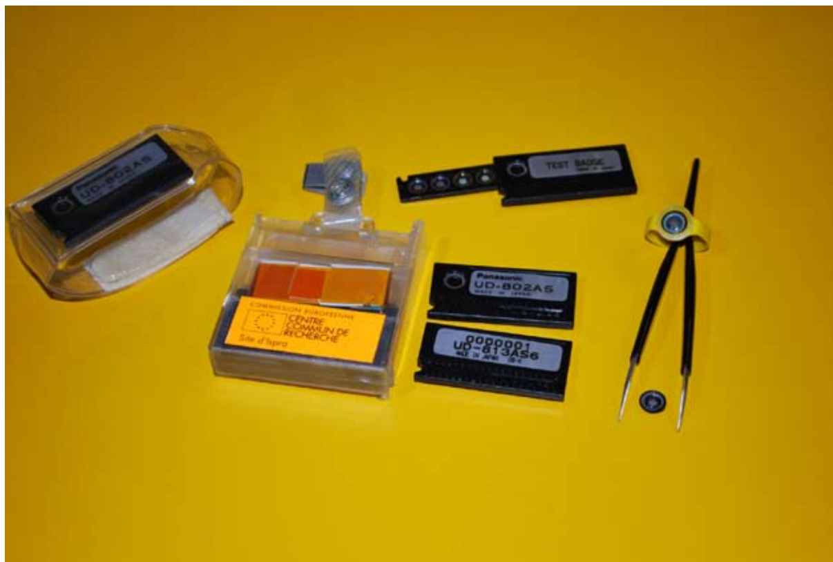
Figura 1 | Dosimetri personali: bracciale, corpo intero, anello.
