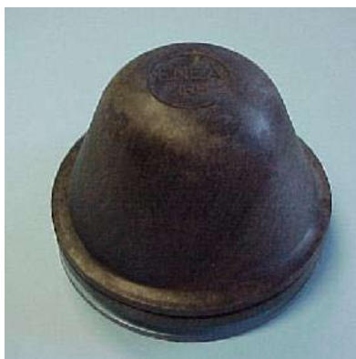
Dispositivo passivo a tracce di tipo chiuso per la misurazione della concentrazione di radon in aria
