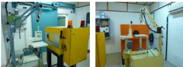
Figura 1 | Irraggiatori multisorgente: sala con sorgenti gamma di media e bassa attività.
