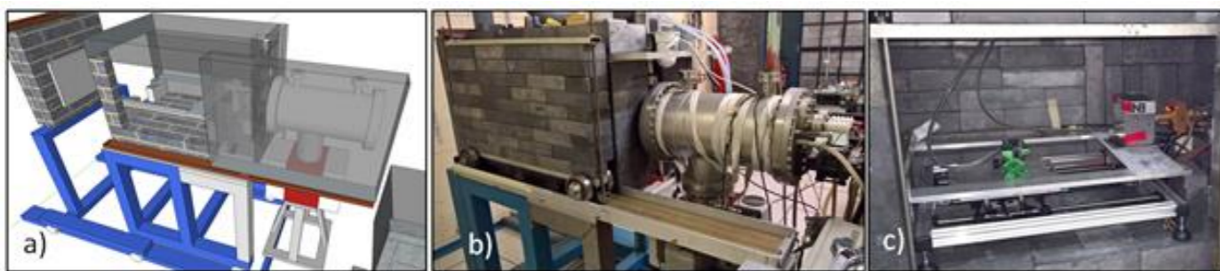
Schema a) e foto b) del LINAC per la produzione di RI e della camera di irraggiamento rispettivamente. C) interno della camera di irraggiamento con il target di conversione ed il collimatore di piombo [3] per la RI e la strumentazione di misura del rateo di dose
