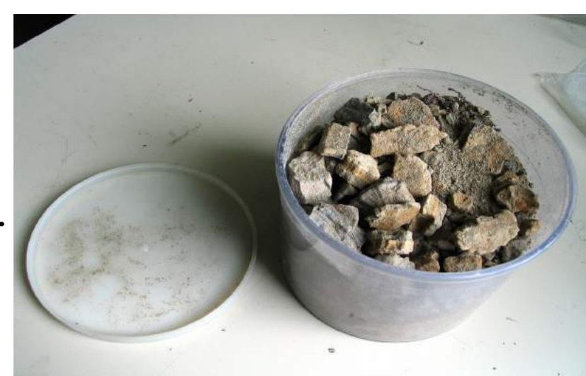
Campione di fango oleoso di risulta, proveniente dalla dismissione dell'impianto, ad elevata concentrazione di 226Ra non omogeneizzato
